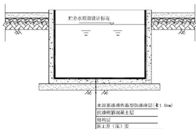
图 7.6-5 污水池防渗层示意图
